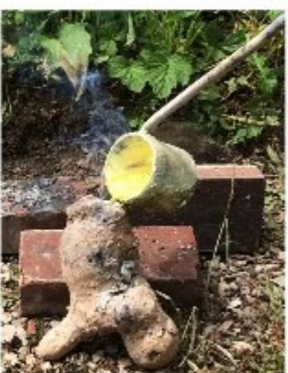
Chauffe du métal dans le four puis fonte dans le moule d'argile
